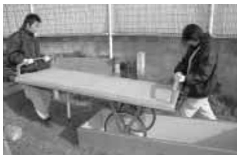
スツールの上部を外せば炊き出しのかまどに(左)、災害時にベンチの上部を動かせば大八車に(右)、それぞれ変わり活用できるようになっています。(志水防災広場)
