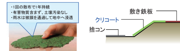
図 3-9. 土壌表面の固化状況とクリコート散布範囲
