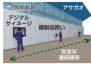
図 3-1. 既存施設利用者の安全対策
