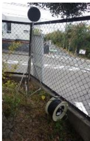
図 4-3 市道騒音測定の様子
