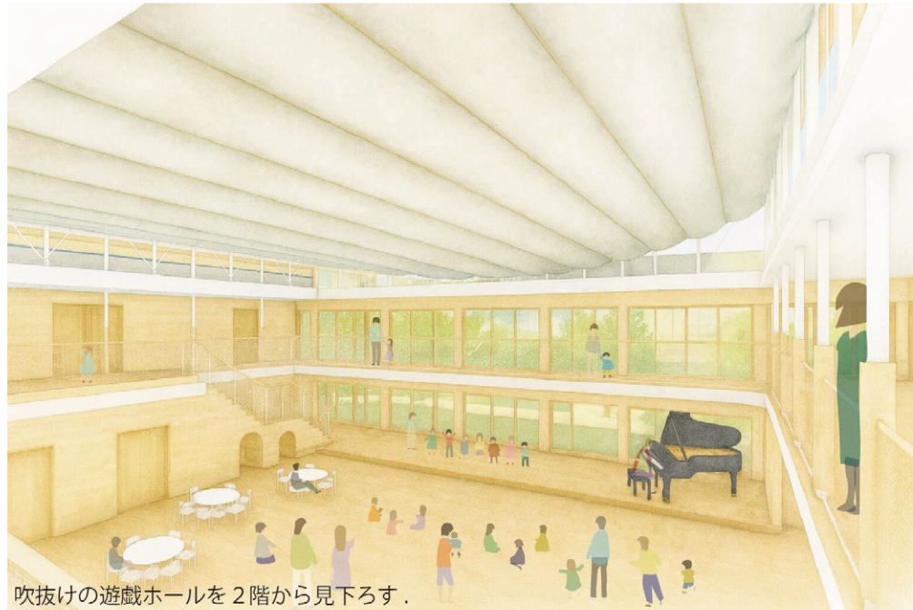
遊戯ホール1階・大スパンを飛ばせる張弦梁が無柱空間を実現。
