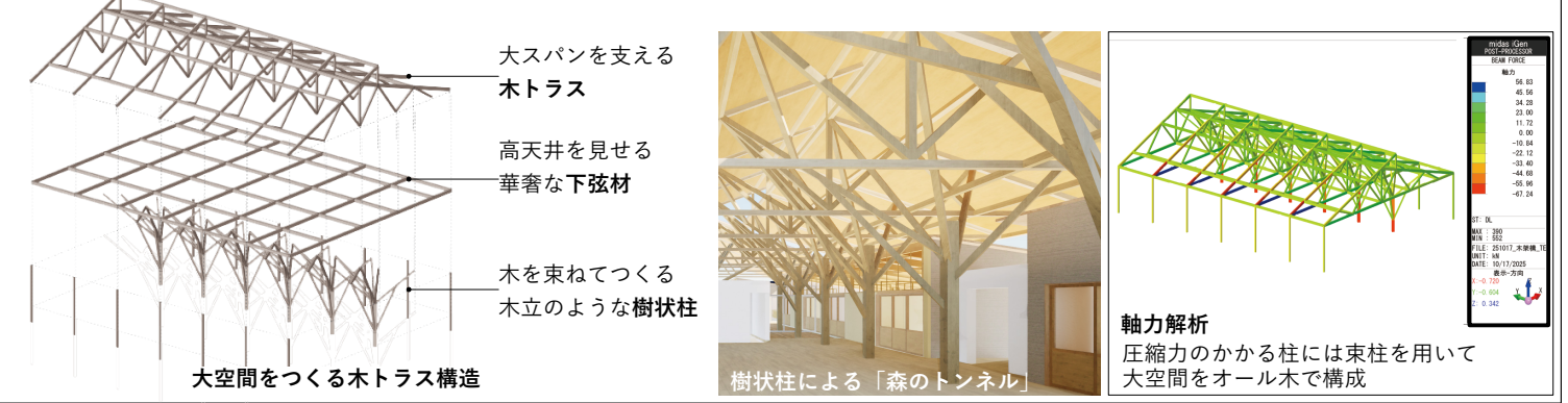
トラスと樹状柱による大空間 構造的合理性と詩的な空間性を兼ね備える
